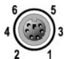
図B-4 PS/2 互換キーボードおよびマウスコネクタのピン番号
